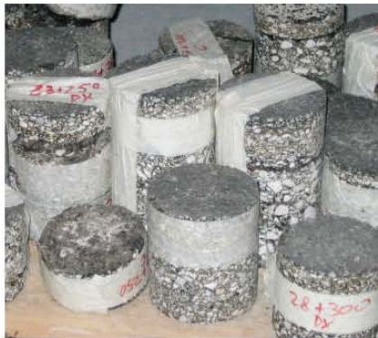
Campioni di conglomerato bituminoso prelevati in cantiere mediante carotatrice elettrica
