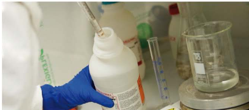
Titolazione di un campione estratto mediante attacco chimico
