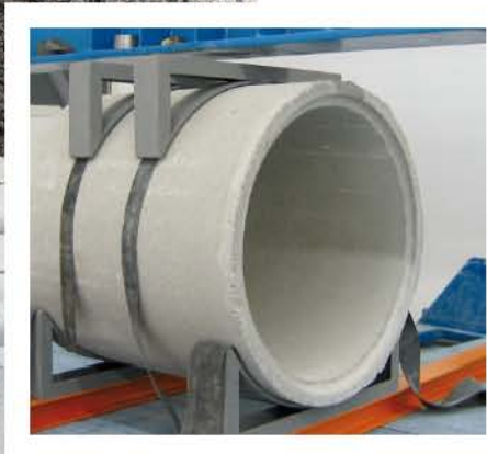
Determinazione della resistenza a momento flettente longitudinale di un tubo circolare
