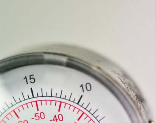
Verifica della taratura di una macchina di compressione
